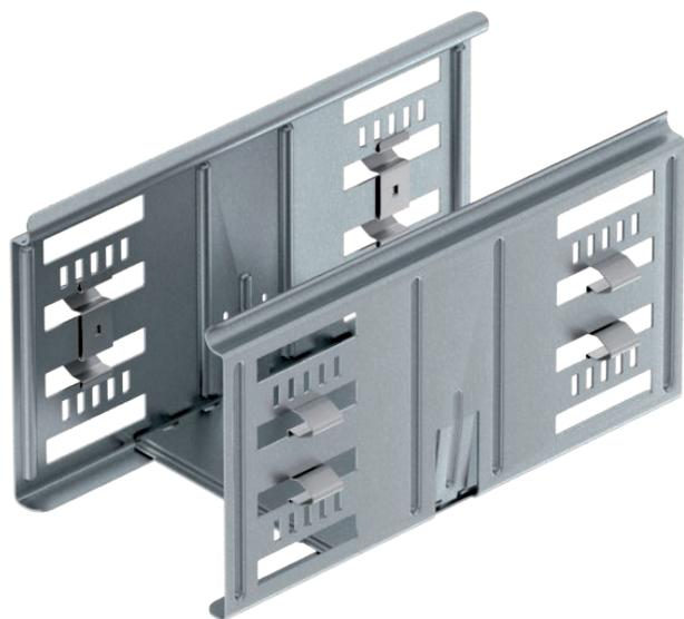
Соединитель кабельного лотка с быстрым креплением для соединения перфорированных кабельных лотков с высотой боковой стенки 110 мм без винтов.
