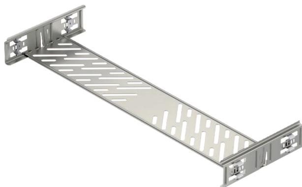
Соединитель кабельного лотка с быстрым креплением для соединения перфорированных кабельных лотков с высотой боковой стенки 60 мм без винтов.
