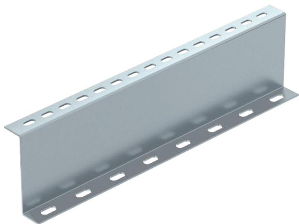
Опорный кронштейн для крепления системы кабельных лотков BKRS на полу. Z-образный профиль для увеличения жесткости конструкции, а также от попадания инородных тел в пространство под лотками.
