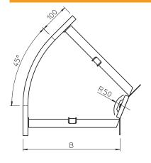
200,00 мм Ширина Высота боковой стенки 35,00 мм Размер В 200,00 мм Размер R 50,00 мм Изгиб (угол) 45° Конструкция соединителей Соединитель в комплекте Предназначено для поддержания функций Монтажные отверстия в основании Схема расположения отверстий NATO горизонтальный Изменение направления Нержавеющая сталь, протравленная Боковая перфорация Исполнение для больших расстояний
