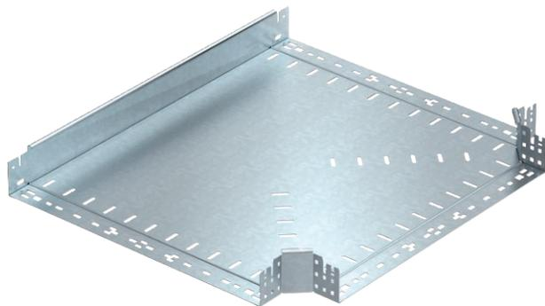
T-образное/крестовое соединение с системой соединителей для быстрого монтажа. Для всех типов кабельных лотков, высота боковой стенки которых составляет 85 мм.
