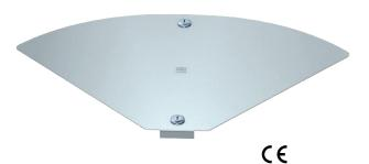
Крышка для угловой секции, варьируется в диапазоне от 0 до  $90^\circ$ , фиксация обеспечивается благодаря защелке и соединению внахлест с крышкой кабельного канала.
