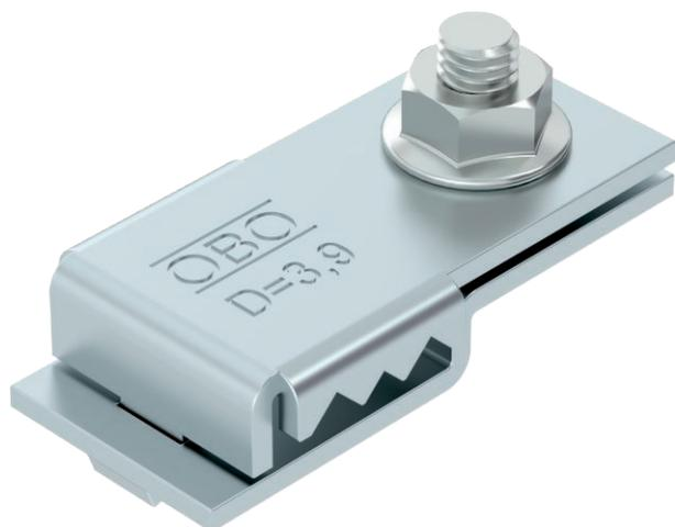
Клемма соединения и заземления служит для уменьшения электрического сопротивления и, соответственно, улучшения электрической проводимости систем проволочных лотков GRM в месте соединения. Это обеспечивает соответствие требованиям по переходному сопротивлению, предъявляемым, например, NEMA и CSA. Клемма соединения и заземления обязательно требуется при использовании системы проволочных лотков в качестве защитного проводника (необходимо соблюдать местные предписания по созданию такой системы).
