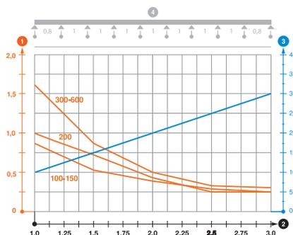
Диаграмма нагрузки на проволочный лоток типа GRM 105
