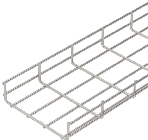
Проволочный лоток из стальной проволоки, соединенной точечной сваркой, с боковыми стенками высотой 55 мм.
