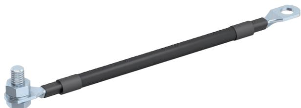
УФ-устойчивый соединительный провод (медь 25 мм<sup>2</sup>) для монтажа разделительных искровых промежутков, тип EX ISG на изоляционных фланцах и изоляционных частях. С обеих сторон с кабельным наконечником для винтов M10, с одной стороны с винтом M10, гайкой и пружинным кольцом.
