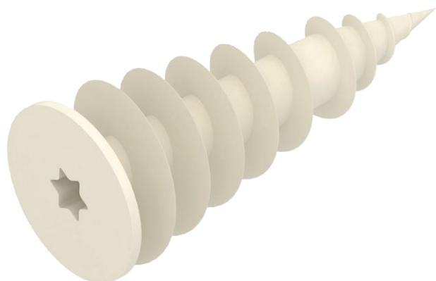
Дюбель для универсального простого крепления в оштукатуренных теплоизоляционных композитных системах (ETICS). Саморез устраняет необходимость предварительного сверления
