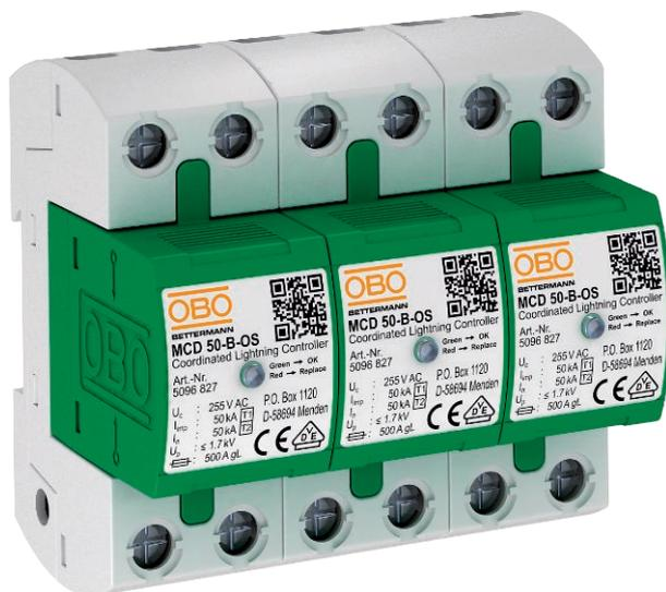
Комплект комбинированных разрядников тип 1+2, 3-полюсные с индикацией рабочего состояния, для использования в сетях TN-C; комплект полностью собран и готов к подключению. Состоит из трех MCD 50-B-OS: комбинированный УЗИП тип 1+2 согласно стандарту EN 61643-11. Переход от зоны молниезащиты 0 к 2 (LPZ) согласно концепции зон молниезащиты по стандартам IEC 61312-1 или ГОСТ Р МЭК 62305
