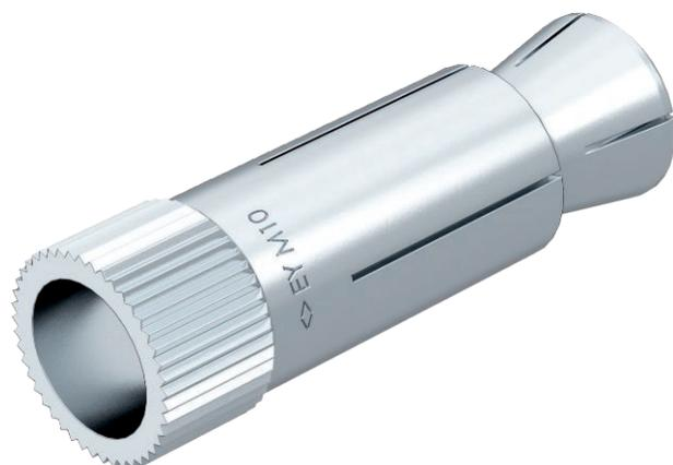
Анкер для полых перекрытий Easy предусмотрен для монтажа в полых перекрытиях из армированного бетона. При затягивании болта или гайки конус втягивается в анкерную гильзу. Дюбель раскрывается в монтажном пространстве и фиксируется, приняв определенную форму. Анкер для полых перекрытий также может применяться и не в полых пространствах. Крепление элементов может осуществляться с помощью стандартных болтов и стержней с резьбой.
