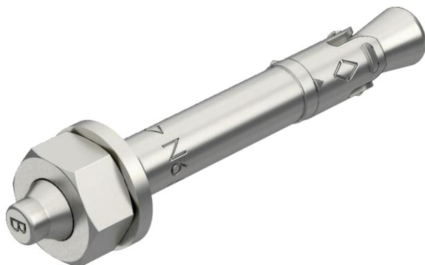
Анкерный болт N применяется для универсального крепления не несущих систем в растянутом и сжатом бетоне. Для монтажа анкерного болта достаточно установить его в просверленное отверстие. Закручивать анкерный болт при этом не требуется. При воздействии нагрузки анкерный болт автоматически раскрывается и надежно фиксируется в просверленном отверстии.
