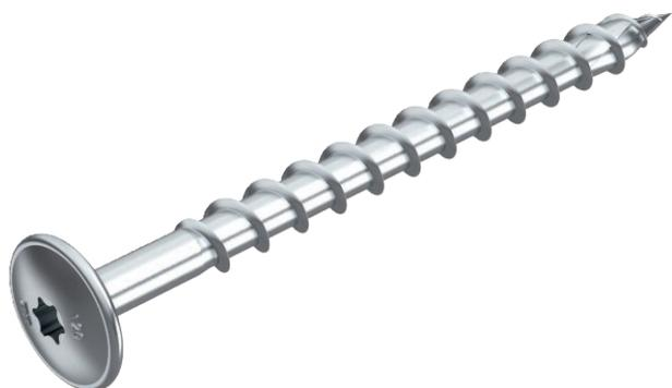
Саморез для огнестойкого крепления кабельных устройств для сохранения функциональности по стандарту DIN 4102, часть 12, на элементах несущих деревянных конструкций. Благодаря форме головки возможна установка без дополнительной подкладной шайбы.
