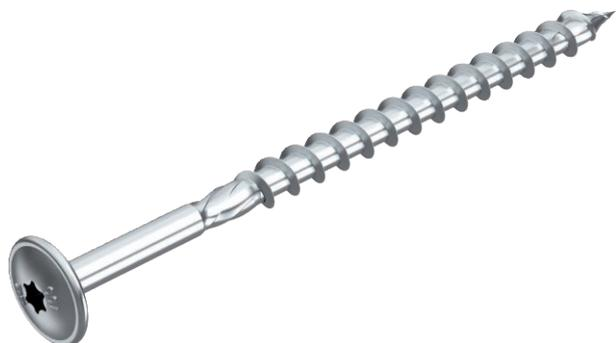
Саморез для огнестойкого крепления кабельных устройств для сохранения функциональности по стандарту DIN 4102, часть 12, на элементах несущих деревянных конструкций. Благодаря форме головки возможна установка без дополнительной подкладной шайбы.
