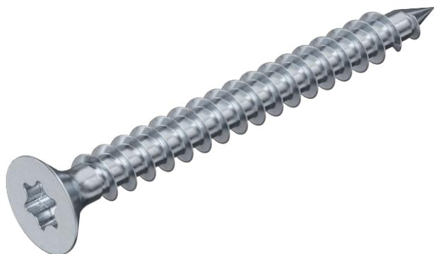
Из закаленной стали гальванически оцинкованной, пассивированной, имеет покрытие из хостафлона, потайная головка с T-Bit (внутренний шестигранник), разм. диаметр 3 мм T10, диаметр 3,5 мм T15, диаметр 4 и 4,5 мм T20, диаметр 5 мм T25.
