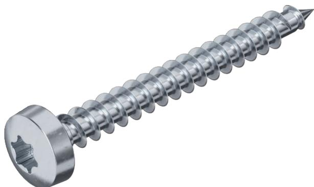
Из закаленной стали гальванически оцинкованной, пассивированной, имеет покрытие из хостафлона, плоскоконическая головка с T-Bit (внутренний шестигранник), разм. диаметр 3 мм T10, диаметр 3,5 мм T15, диаметр 4 и 4,5 мм T20, Ø 5 мм T25
