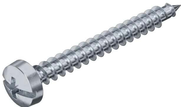
Из закаленной гальванически оцинкованной стали с желтым хромированным, а также хостефлоновым покрытием. Плоская головка с комбинированным крестовым и продольным шлицем под отвертку (Pozidrive Gr. 2, кроме Ø 6 мм, Pozidrive Gr. 3).
