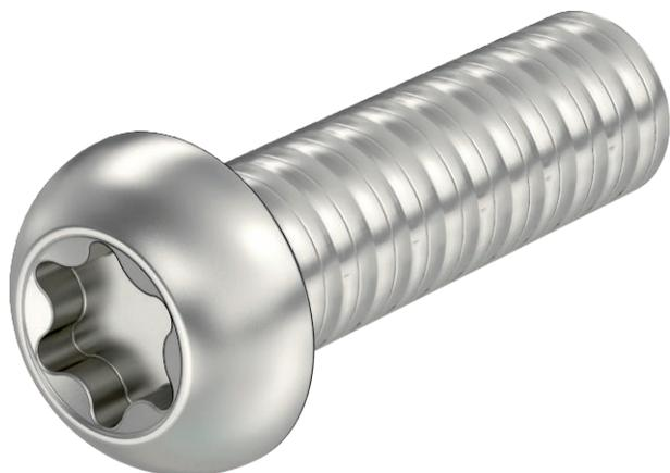
Болт с плоской головкой с TX 30, согласно ISO 7380-1, подходит для крепления кабельных лотков на кронштейнах, а также для монтажа разделительных полочек. Благодаря округлой форме обеспечивается защита кабеля. Шлиц Torx осуществляет оптимальный перенос силы при закручивании.
