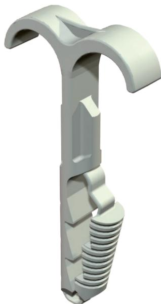
Нажимной фиксатор для крепления проводов и труб к стене и потолку, а также для укладки гибких труб на бетонном и бесшовном полу. Двойные нажимные фиксаторы заменяют скобы с гвоздём в бетоне и в газобетоне. Преимущество нажимных фиксаторов в том, что их нужно просто вставить в отверстие. Дюбели и винты не требуются.
