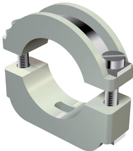
Молниезащитная скоба ISO: пластмассовая скоба с металлической вкладкой, таким образом, выдерживающая очень большую нагрузку; металлическая часть изготовлена из оцинкованной стали.
