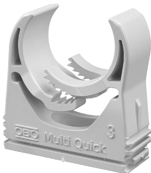
Зажим Multi-Quick с резьбой PG и метрической; для простого крепления и надежной фиксации, для установки в ряд; диапазон зажима: 15-37 мм; зажим универсален в применении, легко крепится в ряд на рейках типов 2060 и 2061.
