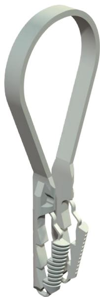
Стяжной хомут для фиксации проводов, гибких труб и всех типов изоляционных и армированных труб, подходит для бетона, силикатного кирпича и полнотелого кирпича. Использование в газобетонной стене возможно, но необходимо учитывать снижение несущей способности.
