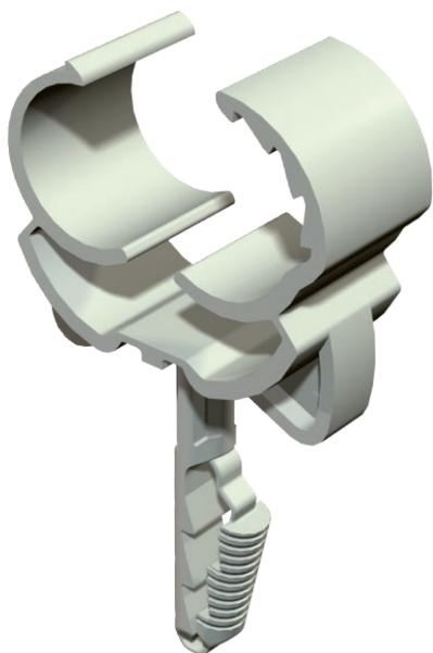
Зажим Klick-Snap со вставным дюбелем для быстрой установки в бетонных и кирпичных стенах. При монтаже необходимо вставить дюбель в отверстие, слегка надавить; когда вставляется труба, лапки зажима защелкиваются и фиксируются вокруг нее.
