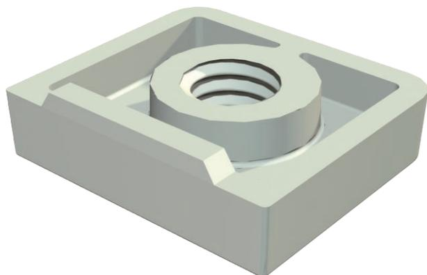
Гайка starQuick специально разработана для использования со скобой starQuick. Необходимо просто вставить ее в специально предусмотренное отверстие скобы. Гайка надежно фиксируется в скобе. Подходит для резьбы M6.
