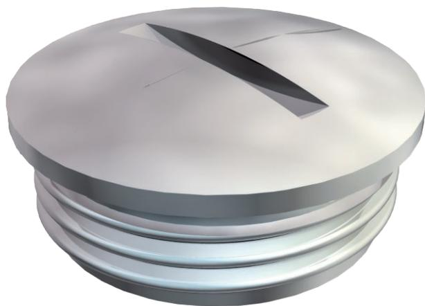
Заглушка N согласно DIN 46320, с метрической резьбой согласно DIN EN 60423 или ISO 68. В сочетании с уплотнительным кольцом типа 107, 170 или 171 степень защиты IP 68 (5 Бар/1 ч).
