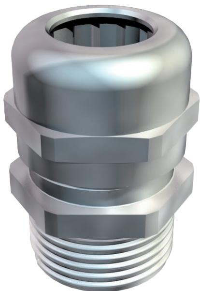
Жесткий кабельный ввод с глухой гайкой с большим диапазоном плотности с метрической соединительной резьбой по IEC 423 в конструкции с глухой гайкой для высоких требований герметичности. Разгрузка от натяжения, защита от прокручивания и герметичность по всей области зажима. Для более толстых стенок корпуса в сочетании с контргайкой.
