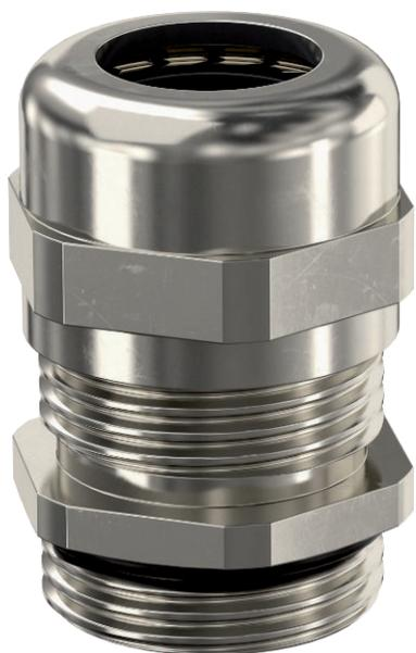
Жесткий кабельный ввод с метрической соединительной резьбой по IEC 423 в конструкции с глухой гайкой для высоких требований герметичности. Разгрузка от натяжения, защита от прокручивания и герметичность по всей области зажима. Уплотнительное кольцо из неопрена. Зажим из полиамида. С заранее установленным уплотнительным кольцом на соединительной резьбе, проверено VDE согласно DIN EN 50262, степень защиты IP68 при 5 бар/1 ч.
