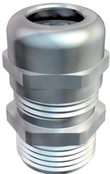
Кабельный ввод с большим диапазоном плотности, а также разгрузкой от натяжения и защитой от сильного перекручивания, с соединительной резьбой Pg согласно DIN 40430, для более толстых стенок корпуса поставляется вместе с контргайкой. Зажим из полиамида.
