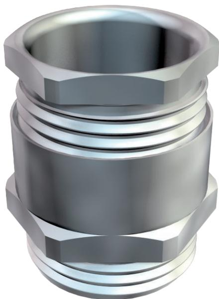
Кабельный ввод, шестигранный, форма C4 в соответствии с DIN 46320 с метрической соединительной резьбой в соответствии с DIN EN 60423 или ISO 68. Прижимные кольца из стали, гальванически оцинкованные и хромированные.
