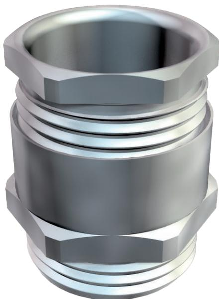
Кабельный ввод, шестигранный, форма С4 в соответствии с DIN 46320 с соединительной резьбой Pg в соответствии с DIN 40430. Прижимные кольца из стали, гальванически оцинкованные и хромированные. Уплотнительное кольцо из NR/SBR. степень защиты: с уплотнительным кольцом на резьбе IP65, без уплотнительного кольца на резьбе IP54. С уплотнительным кольцом с выемкой.
