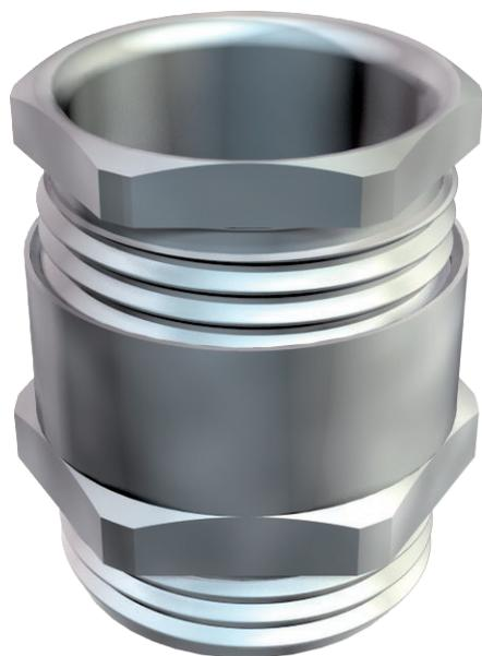
Кабельный ввод, шестигранный, форма С4 в соответствии с DIN 46320 с соединительной резьбой Pg в соответствии с DIN 40430. Прижимные кольца из стали, гальванически оцинкованные и хромированные. Уплотнительное кольцо из NR/SBR.
