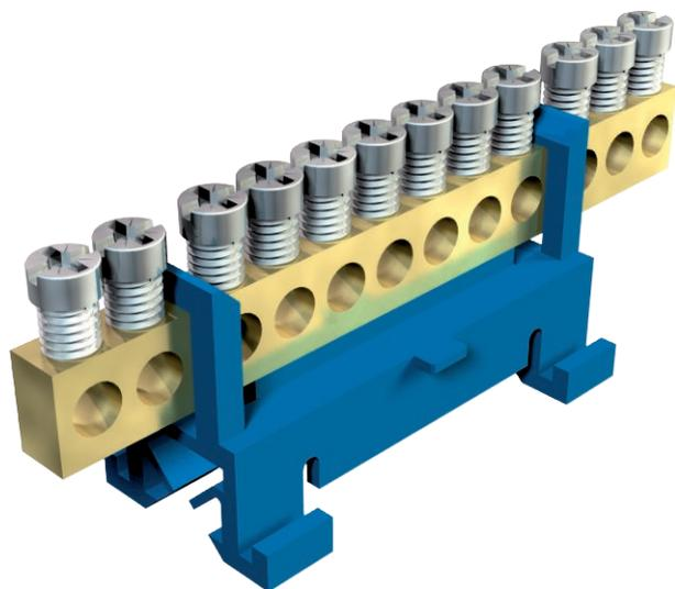
Клеммы для подключения нулевого провода с 12 клеммными контактами до 16 мм<sup>2</sup>. Клеммная колодка из латуни, стальные винты, оцинкованы гальваническим способом, с прозрачной пассивацией, для установки на профильные рейки 35 мм по стандарту DIN EN 60715 - ранее DIN EN 50022- (поперечные) или плоские рейки 10 x 2-2,5 мм (продольные).
