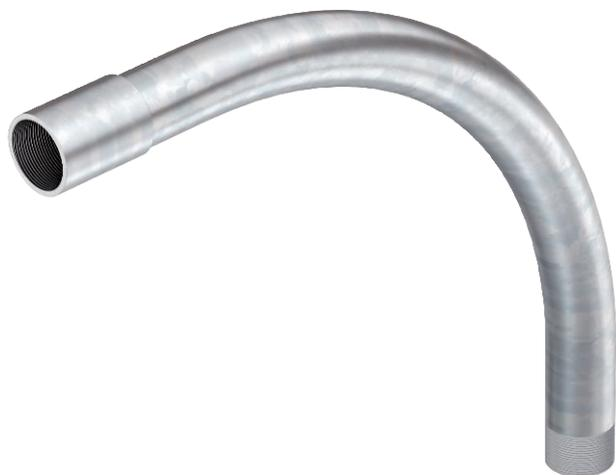
Дуга 90° для электромонтажных труб согласно EN 61386-1 с резьбовыми концами в соответствии с DIN EN 60423. С внутренней стенкой без заусенцев.
