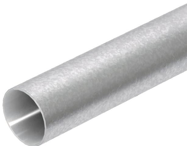
Электромонтажная труба согласно EN 61386-1 без резьбы на концах для механической защиты кабеля и проводов. С внутренней стенкой без заусенцев. С защитой от коррозии 4 класса (высокая).
