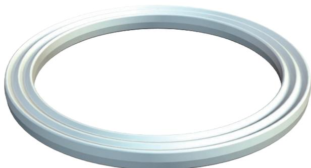
Уплотнительное кольцо для соединительной резьбы соответствует DIN 46320 часть 9, но размеры отличаются в зависимости от материала и функций; подходит для всех кабельных вводов из пластика с резьбой Pg согласно DIN 40430. Внутренний диаметр уплотнительных колец сделан так, что после установки они не могут выпасть из вводов.
