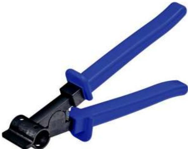
При помощи разжимных клещей можно открыть уплотнительную вставку. Это позволяет легко и быстро уложить отдельные кабели. Для этого вставьте кабель в разжимные клещи, вставьте разжимные клещи в разделительную перегородку и откройте. Теперь кабель можно удобно поместить в уплотнение.
