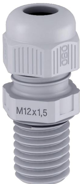
Самый быстрый и удобный способ обеспечить разгрузку от натяжения и герметичность, с помощью кабельных вводов на распределительных коробках и корпусах: кабельные вводы V-TEC VM от OBO. Со встроеной интегрированной уплотнительной кромкой и специальной пластинчатой конструкцией OBO достигается класс защиты IP68. Функции разгрузки от натяжения и герметичность протестированы согласно DIN EN 62444.
