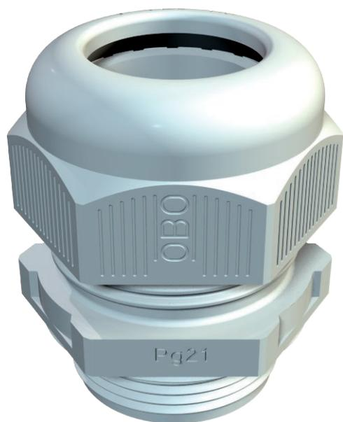
С резьбой подключения Pg согласно DIN 40430, жесткое резьбовое соединение кабеля с колпачковой гайкой с большим диапазоном плотности, а также разгрузкой от натяжения и защитой от скручивания для удовлетворения высоких требований плотности; уплотнительное кольцо из хлоропрена/нитрилового каучука, шприцованное уплотнительное ребро, при этом не нужно уплотнительное кольцо резьбы подключения, протестировано согласно VDE 0619. Степень защиты IP 68 при 5 бар 1 час.
