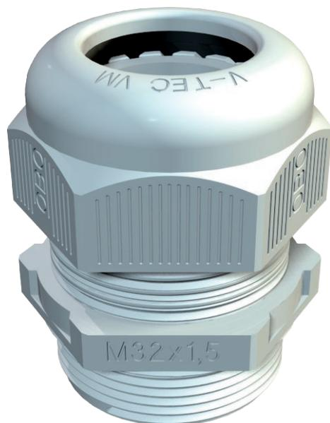
Самый быстрый и удобный способ обеспечить разгрузку от натяжения и герметичность, с помощью кабельных вводов на распределительных коробках и корпусах: кабельные вводы V-TEC VM от OBO. Со встроенной интегрированной уплотнительной кромкой и специальной пластинчатой конструкцией OBO достигается класс защиты IP68. Функции разгрузки от натяжения и герметичность протестированы согласно DIN EN 62444.
