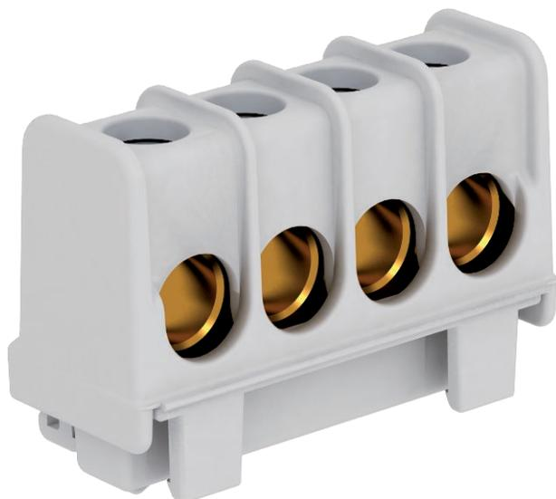
Клеммная колодка и болты из стали, оцинкованной способом и прозрачным пассивированием, номинальное сечение 16 ÷ 35 мм<sup>2</sup>, номинальное напряжение 400 В, 1 контакт, с разъемами, макс. размеры подключаемых сечений для каждой клеммы: 4x35мм<sup>2</sup>, 4x25мм<sup>2</sup>, 8x16мм<sup>2</sup> или 12x10мм<sup>2</sup>.
