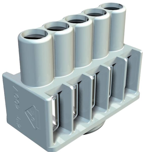
Клеммная колодка и болты из стали, оцинкованной гальваническим способом и прозрачным пассивированием, номинальное сечение 1 ÷ 4 мм<sup>2</sup>, номинальное напряжение 400 В, 5-контактов, с разъемами, макс. размеры подключаемых сечений для каждой клеммы: 3 x 6 мм<sup>2</sup>, 4 x 4 мм<sup>2</sup> или 6 x 2,5 мм<sup>2</sup>.
