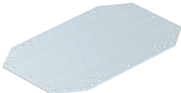
Монтажная/крепежная пластина предусмотрена для фиксации внешних элементов в распределительной коробке. Она изготовлена из оцинкованной стали толщиной 2 мм. В соответствии с формой детали в монтажной пластине высверливаются отверстия. Детали крепятся к пластине с помощью кабельных стяжек, болтов и других элементов. С помощью болтов, поставляемых в комплекте, пластину можно установить в распределительных коробках Т-серии.
