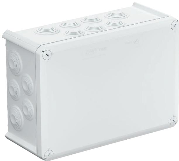
Кабельная распределительная коробка для соединения кабелей и проводов в помещении и в защищенных зонах вне помещения. Прямоугольная форма с вставными уплотнениями по бокам и штамповкой под отверстия на дне. Подходит для настенного и потолочного монтажа и установки на монтажных пластинах. С возможностью для внутреннего закрепления и монтажа поверх угловых колпаков. Крышка с быстроразъемным соединением может быть опломбирована. Изготовлено из материалов, не содержащих галогены.
