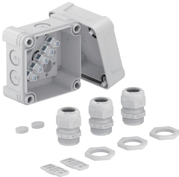
Кабельная распределительная коробка с клеммной колодкой для соединения кабелей и проводов в помещении и вне помещения. Квадратная форма со штамповкой под отверстия. Подходит для настенного и потолочного монтажа с возможностью наружного и внутреннего закрепления и монтажа поверх угловых колпаков. Обладает ударпрочностью с IK09.
