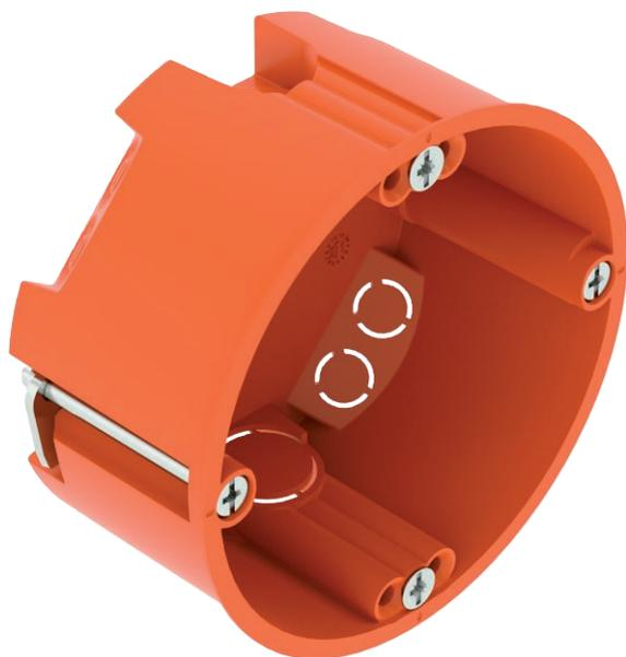
Монтажная коробка для установки в полую стену на глубину не менее 35 мм и с толщиной пластины 5–28 мм.
