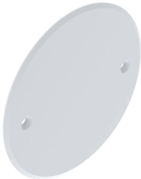
Универсальная крышка монтажной коробки для скрытой установки и для установки в полую стену. С отверстиями, расстояние между отверстиями 60 мм для монтажных и монтажно-соединительных коробок, с утопленными винтами. Шероховатая поверхность.
