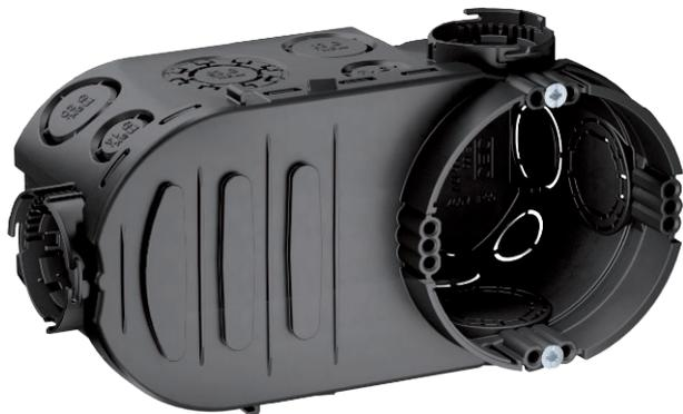
Монтажная коробка для скрытой установки электроники с дополнительным пространством для клемм в кирпичную кладку на глубину не менее 66 мм.
