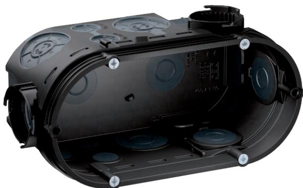
Двойная монтажная коробка для скрытой установки в кирпичную кладку с воздухонепроницаемыми мембранными вводами на глубину не менее 66 мм.
